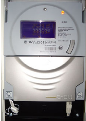
Abbildung 3-8: EnBW Smart Meter mit Display und DSL Anschluß
