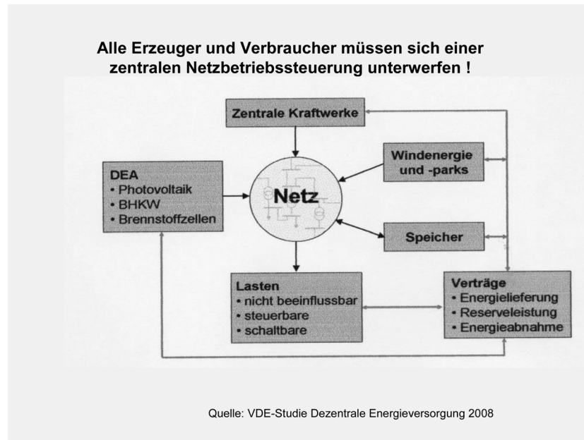
Bild 4: Schema für das zentrale Netzmanagement in einem integrierten Netz.
