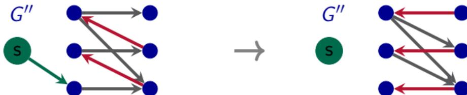
In jeder Iteration wird das Matching um 1 erhöht (terminiert also spätestens nach  $|M| \leq |V|/2$  Iterationen; pro Iteration eine BFS in Polynomialzeit).
